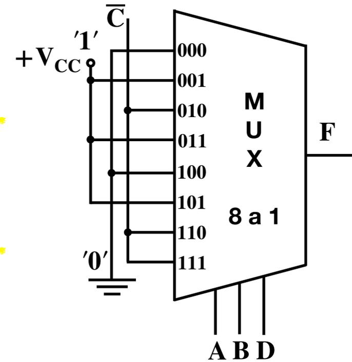
MUX de 3 VC: tendré en las entradas solamente 1's, 0's y la variable independiente no tomada negada y sin negar.
